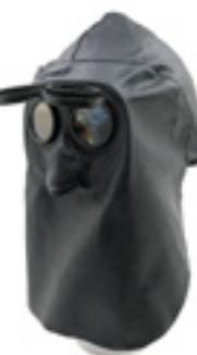
Schwarze Lederkopfhaube, hinten offen, hochklappbare Brille mit eingebauter Anstoßkappe zum Schutz der Schädeldecke. Innenseite farblose Scheiben, Klappe für grüne Gläser vorgesehen. Für Glasgröße ø 50 mm, AZO und PCP frei. Zugelassen nach EN 175.
