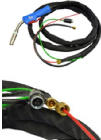
Für Schweißmaschinen mit Direktanschluss. Schlauchpaket mit 3-poligem Tuchelstecker, evtl. muss dieser abgeschnitten werden und die Steuerleitung in der Maschinen direkt angeklemt werden.
