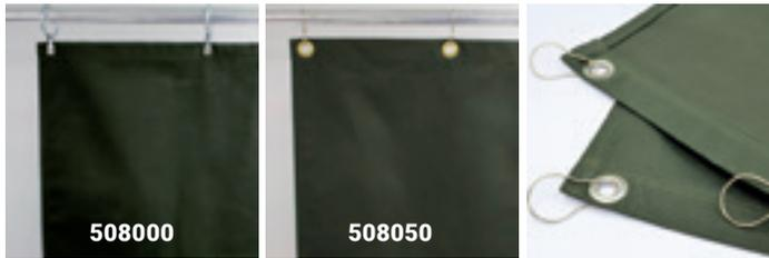
Vorhänge aus Baumwoll-Jute-Gewebe, schwer entflammbar (Klasse B1) nach EN 13501-1, selbstverlöschend, olivgrün mit angenieteten Metallringen ø 50 mm, 90° zur Achse (siehe Abb.) oder mit Edelstahlösen (Innen-ø 16 mm), ca. alle 30 cm an der Aufhängeseite. Flächengewicht des Materials: 440 g/m².
