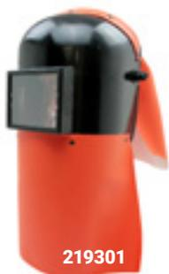
Kopfschutzhaube mit Nackenschutz und zusätzlichem Schutzlatz, aus schwarzem Kunststoff (PE), für leichte Sandstrahlarbeiten, zugelassen nach EN166, Schutzscheiben außen Mineralglas, innen Kunststoffscheibe, Glasgröße 90x110 mm, komplett mit verstellbarem Kopfeinsatz **216500**.
