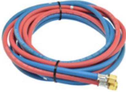
Doppelschlauch, Azetylen-schlauch 4x3,5 mm und Sauerstoffschlauch 4x3,5 mm, beidseitig konfektioniert mit Tülle und Überwurfmutter 1/4" RH bzw. 3/8" LH und Doppelschlauchschele. Europäische Qualität.
