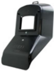
Handschuttschild aus schwarz-grauem ABS Kunststoff, gekröpfte Ausführung, zugelassen nach EN 175. Für Glasgröße 90x110 mm und mit Adapter 51x108 mm. Ausführungen in ABS, Temperaturbeständig bis ca. 120 °C. Es können alle Schweißerschutzgläser bis zur Schutzstufe DIN 14 sowie Vorsatzscheiben bis zur Stärke 2 mm eingesetzt werden.
