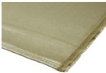
Silikat Gewebe bis maximal 1.000 °C, mit Glimmer Beschichtung zur zusätzlichen Flammbeständigkeit. Beständig gegen Funken, Metallspritzer und flüssiges Metall. Maximale Breite 0,92 m, Länge max. 50 m, Flächengewicht 1.100 g/m<sup>2</sup>
