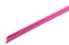
ISO 3677, B-Cu60Zn(Si)(Mn); DIN EN 1044, CU 301 (früher L-CuZn40, DIN 8513). Zum Hartlöten von Kupfer, Nickel und Stahl sowie zum Schweißen von Messing und Bronze. 500 mm lange Stäbe im Karton à 5 kg. Arbeitstemperatur 900 °C.
