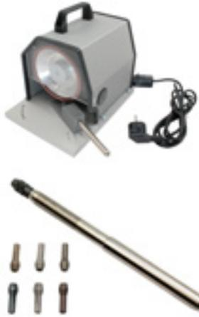
Type EAG-3, kompl. mit Antriebsmotor 230 V, einer Diamantschleifscheibe in Metallbindung und Aufnahmestift für die Elektroden. Spannangen für alle Wolfram-Elektroden von  $\varnothing$  1,0-4,0 mm, insgesamt 6 Stück. Es können Elektroden ab 20mm Länge geschliffen werden.
