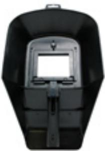
Freisichtschutzschild aus schwarzgrauem ABS-Kunststoff, gekröpfte Ausführung, zugelassen nach EN 175. Glasgröße 90x110 mm. Vollkunststoff-Freisichteinrichtung. Der Glasrahmen mit dem Schweißerschutzglas wird mit dem Daumen nach unten weggezogen, dadurch wird der Blick frei zur Schweißstelle. ABS Temperaturbeständig bis ca. 120 °C.
