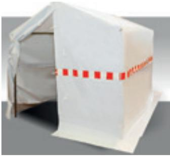
Giebel in der Mitte geteilt, PVC-beschichtetes PES-Gewebe 600 g/m<sup>2</sup>, Farbe weiß/transluzent, schwer entflammbar. Stahlrohrgestüt  $\varnothing$  32 mm goldpassiviert, zusammenlegbar. Umlaufender Warnstreifen.
