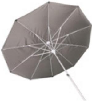
Arbeitsschirm „Premium“, robuste Ausführung, Aluminiumstock 38/42 mm, Aluminiumstreben 20x12 mm mit Glas-fiberstangen, Schirmhautaufnahme in Metallendhülsen Baumwollgewebe 350 g/m<sup>2</sup>, wasserdruckbeständig, fäulnis-hemmend, schwer entflammbar nach DIN 4102 B1, Farbe oliv
