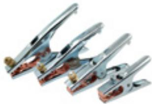
Hochwertige vernickelte Stahlklemmen mit hoher Spannkraft und Elektrolythkupferverbindungen. Obere und untere Kontaktteile mit Kupfergeflecht verbunden. Die Einlagen sind ideal zum Klemmen auf Röhren und Flachmaterial!
