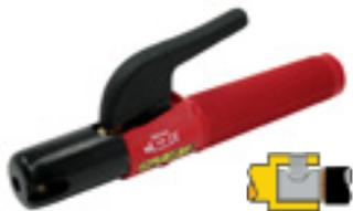
Elektrodenhalter komplett isoliert. Mit Messingunterteil, Messinggusshebel, schwarzer geschlossener Schale, rotem glasfaserverstärktem Handrohr und geripptem Griffbereich. Kabelklemmanschluss. Ampere-Angaben bei 35 % ED.
