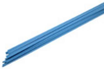
ISO 3677, B-Cu48ZnNi(Si), DIN EN 1044, CU 305 (früher L-CuNi10Zn42, DIN 8513). Zum Hartlöten von Stahl, Temperguss, Nickel, Nickel-Legierungen und Gusseisen. 500 mm lange Stäbe im Karton à 5 kg.
