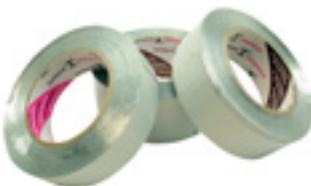
Gerband 712-A2 besteht aus weichgeglühter Aluminiumfolie die einseitig mit einem schwerentflammaren lösungsmittelfreien Reinacrylatkleber beschichtet ist. Zum Abkleben von aluminiumkaschierten Dämmstoffen, Ummanteln von Heizrohren und Lüftungskanälen sowie zum Abdichten von Behältern und Rohren beim Schweißen unter Schutzgas.
