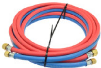
Zwillingsschlauch, Azetylen-schlauch 6x3,5 mm und Sauerstoffschlauch 6x3,5 mm, beidseitig mit Tülle und Überwurfmutter 1/4" RH bzw. 3/8" LH. Europäische Qualität.
