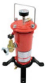
Stand-Filter für APOLLO Strahlhelm zur Reinigung der Druckluft. Öl- und Staubteilchen sowie Wasserdampf werden herausgefiltert; mit Ablasshahn für Kondenswasser. Haltbarkeit des Filters bei 40 Stunden/Woche ca. 3 Monate.
