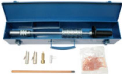
Ausbeulgerät, steckbare Nageldüse für Plus 15, Kohleadapter und Kohleelektrode im Metall-Transportkoffer. Aufgeschweißte Nägel können mit dem Spannkopf geklemmt werden und Blech damit herausgezogen werden.
