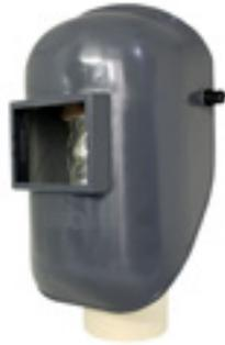
Schutzschirm aus grauem glasfaserverstärktem Polyamid, leichter Glaswechsel durch Eindrücken eines Glashalterahmens. Zugelassen nach EN 175 S, Glasgröße 90x110 mm. Kopfeinsatz ist stufenlos verstellbar.
