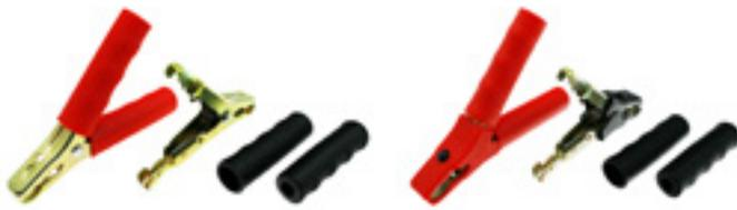
Verzinktes Stahlblech rote/schwarze Kunststoffgriffe, bis 80 A belastbar, Größe 112x90 mm, Anschluss- $\phi$  4,5 mm Kabel anquetschbar mit Zugentlastung.
