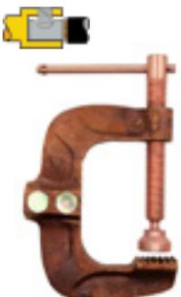
Masseklemme aus Messing-Guss, Spindel aus Stahl, verkupfert, Spannweite 80x60 mm, Kabelklemmanschluss bis 95 mm<sup>2</sup> möglich. bei 60 % ED 500 A, 30 % 600 A.
