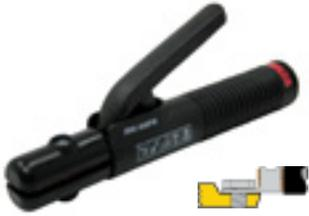
Elektrodenhalter komplett isoliert mit glasfaserverstärktem Handrohr für höhere Temperaturbelastungen. Mit Messingunterteil, Messinghebel, schwarzen Schalen und Kabelschuhanschluss. Ampere-Angaben bei 35 % ED.
