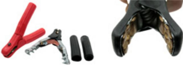
Verzinktes Stahlblech rote/schwarze Kunststoffgriffe bis 600 A belastbar, Größe 155x135 mm. Kabel anquetschbar mit Zugentlastung. Beidseitige Messingeinlage und Kupfergeflechtverbindung, mit Anschluss- $\varnothing$  6,5 mm.
