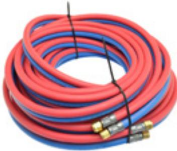
Azetylen- 9x3,5 mm und Sauerstoffschlauch 6x5,0 mm, beidseitig mit Tülle und Überwurfmutter 1/4"RH bzw. 3/8" LH. Europäische Qualität.
