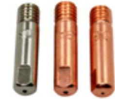
Stromdüse, mit Außengewinde M5 für Type 10 und M6 für Type 15/24 und verschiedenen Bohrungen für Schweißdraht.
