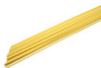
ISO 3677, B-Cu59ZnSn(Ni)(Mn)(Si) DIN EN 1044, CU 306 (früher L-CuZn39Sn, DIN 8513). Zum Hartlöten von Kupfer, Nickel und Stahl sowie zum Schweißen von Messing und Bronze; besonders geeignet zum Hartlöten von verzinktem Stahlblech. 500 mm lange Stäbe im Karton à 5 kg. Arbeitstemperatur 900 °C.
