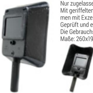
Nur zugelassen zum Schweißen in beengten Räumen. Mit geriffeltem Kunststoffgriff, Kunststoff-Steckrahmen mit Exzenterknopf, für Glasgröße 90x110 mm. Geprüft und eingeschränkt zugelassen nach EN 175. Die Gebrauchsanweisung ist besonders zu beachten! Maße: 260x190 mm, Griff freistehend.
