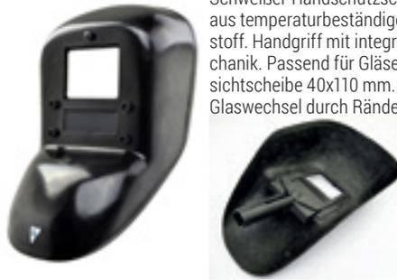
Schweißer-Handschuttschild in gekröpfter Ausführung aus temperaturbeständigem Fiberglas-Verbundwerkstoff. Handgriff mit integrierter Kunststoff-Freisichtmechanik. Passend für Gläser der Größe 90x110 mm, Freisichtscheibe 40x110 mm. Sicherer und werkzeugloser Glaswechsel durch Rändelschrauben. Geprüft und zugelassen nach EN 175.
