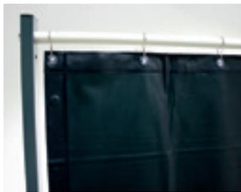
Schweißervorhänge aus Kunststoff-Folie ISO-EN 25980, Breite 1,40 m, Vorhänge allseitig einreißfest gesäumt, 7 Aufhängeösen ø 16 mm und Druckknöpfe zum Aneinanderreihen. Pro Vorhang 7 Aufhängeringe ø 40 mm.
