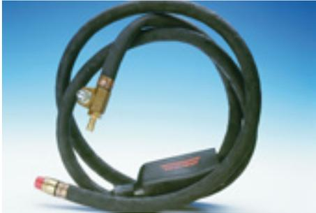
Monoanschlusskabel passend zu Fugenhobler „Flair“. Im Kabel wird der Schweißstrom sowie die Druckluft geführt. Kabel am Plus-Pol anschließen. Arbeitsdruck zwischen 5 und 7 bar. Standardlänge 2,13 m.
