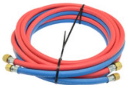
Zwillingsschlauch, Azetylen-schlauch 4x3,5 mm und Sauerstoffschlauch 4x3,5 mm, beidseitig mit Tülle und Überwurfmutter 1/4" RH bzw. 3/8" LH. Europäische Qualität.
