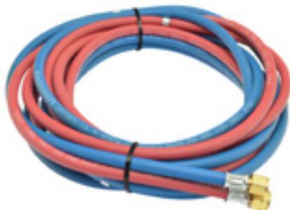
Azetylschlauch 9x3,5 mm und Sauerstoffschlauch 6x5 mm, beidseitig konfektioniert mit Tülle und Überwurfmutter 1/4" RH bzw. 3/8" LH und Doppelschlauchschele, eine Schlauchklemme pro Meter.
