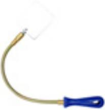
Zur Kontrolle von schwer zugänglichen Schweißpositionen. Spiegel 80x70 mm aus porenfreiem Stahl mit Hochglanzvernickelung, leicht austauschbare wärmeunempfindliche Spiegel.
