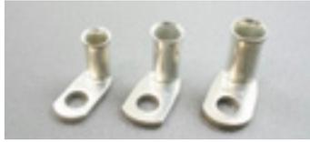
Rohrkabelschuh 90° gekröpft für feindrähtige Leiter, aus E-Cu gemäß EN13600, galvanisch verzinkt, ohne Sichtloch.
