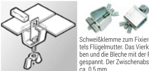
Schweißklemme zum Fixieren von Stahlblechen mittels Flügelmutter. Das Vierkantstück wird eingeschoben und die Bleche mit der Flügelmutter anschließend gespannt. Der Zwischenabstand der Bleche beträgt ca. 0,5 mm.
