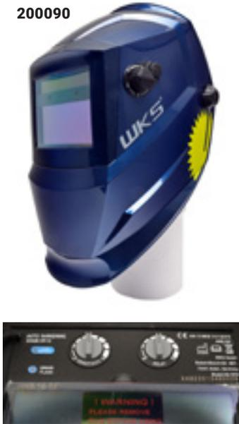
Automatischer Schweißer Kopfschirm mit farbgerechter Filterkassette. Von außen einstellbare Abdunkelung von DIN 9-13 und manuell aktivierbarem Schleifmodus in der Hellstufe DIN 4. Empfindlichkeit und Aufhellverzögerung sind innen an der Kassette stufenlos einstellbar.
