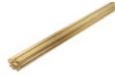
ISO 3677, B-Cu60Zn(Si)(Mn); DIN EN 1044, CU 303 (früher L-CuZn40, DIN 8513). Zum Hartlöten von Kupfer, Nickel und Stahl sowie zum Schweißen von Messing und Bronze. 1.000 mm lange Stäbe im Karton à 5 kg. Arbeitstemperatur 890 °C.
