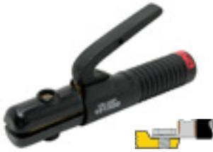
Elektrodenhalter komplett isoliert mit glasfaserverstärktem Handrohr für höhere Temperaturbelastungen. Mit Messingunterteil, Messinghebel, schwarzen Schalen und Kabelschuhanschluss. 150 A bei 35 % Einschaltdauer (ED).
