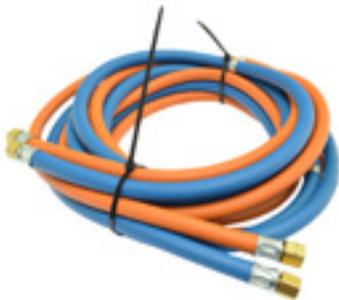
Propangasschlauch und Sauerstoffschlauch beidseitig konfektioniert mit Tülle und Überwurfmutter 1/4" RH bzw. 3/8" LH und Doppelschlauch schelle, eine Schlauchklemme pro Meter.
