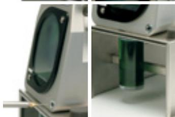
Effizientes und hochwertiges Schleifen von Wolframelektroden
