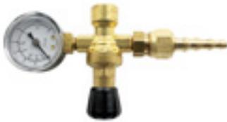
Flaschendruckminderer, einstufig, bis 130 bar Prüfüberdruck mit Sicherheitsmanometer nach EN 562, Inhaltsmanometer: 0-6 bar, Verbrauchsangabe <1 m³/h. Hinterdruck 4 bar.
