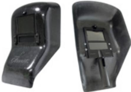
Gekröpfte Ausführung mit Metall-Freisicht-Mechanik und isoliertem Handgriff. Glasrahmenbefestigung mit Rändelmutter. Für Glasgröße 90x110 mm, Freisichtglas 40x110 mm. Zugelassen nach EN 175
