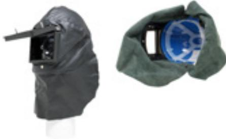
Schwarze Lederkopfhaube, hinten halb-offen, hochklappbarer Rahmen mit eingebauter Anstoßkappe zum Schutz der Schädeldecke. Mit Nackenschutz, Innenseite farblose Scheibe. Für Glasgröße 90x110 mm, AZO und PCP frei. Zugelassen nach EN 175.
