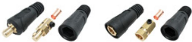
Schweißkabelstecker, Dorn 13 mm für Schweißkabel, Belastung bis 600 A, für Kabel 25, 35, 50, 70, 95 mm<sup>2</sup>. Befestigung mit Inbusschrauben. 120 mm<sup>2</sup> Dorn- $\varnothing$  15 mm. Gebaut und zugelassen nach EN 60974-12.
